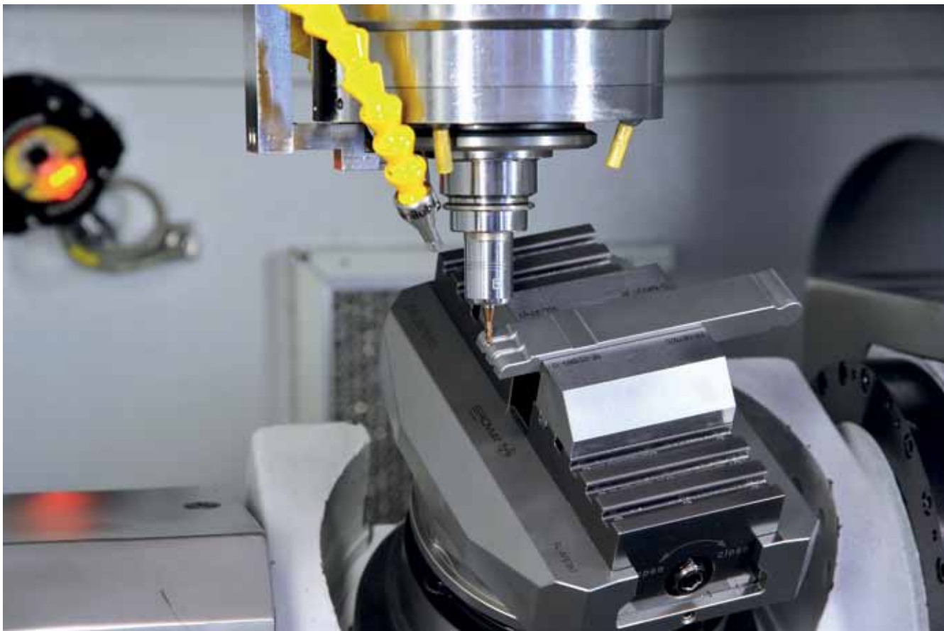
Bild 1: Präzision im \mu -Bereich beim Hartmetallfräsen. Die hydrostatischen Achsführungen der Kern Triton ermöglicht extrem genaue und homogene Bewegungen der Werkzeuge
