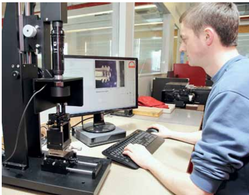
Bild 4: Der Mikrowerkzeuginspektor µ-View: Nach jedem Einsatz werden die Werkzeuge bei 40- bis 450-facher Vergrößerung begutachtet und nach Abnutzung klassifiziert
