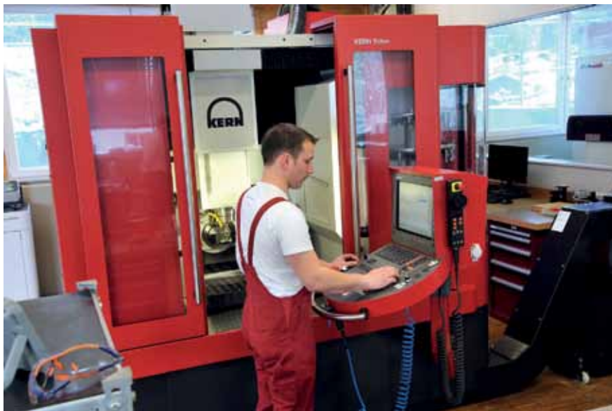
Bild 3: Höchste Genauigkeit im Präzisionsraum: Die Kern Triton hat Unternehmer Peter Wörgartner in einem gesonderten Bereich aufgestellt, der eine hohe Temperaturstabilität hat. Das ergänzt die maschineninterne Temperaturregelung
