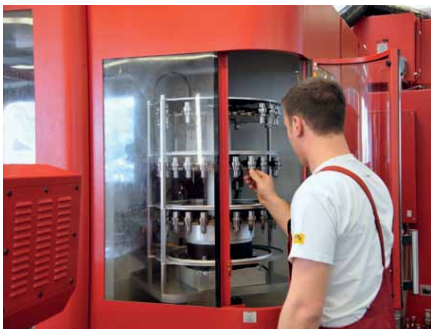
Bild 6: Der übersichtliche Werkzeugwechsler der Kern Triton, bietet bis zu 75 Werkzeugen Platz (Werkbilder: KERN Microtechnik GmbH, Eschenlohe)
