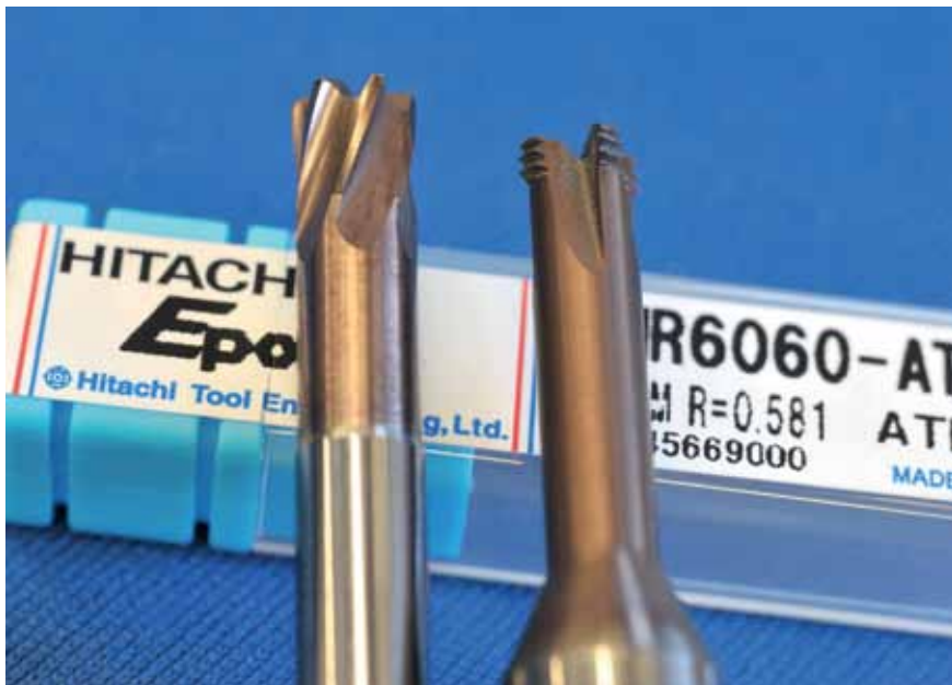
Bild 5: Hochleistungswerkzeuge von Hitachi: Kombiniert mit der Kern Triton fräst der Werkzeugbauer mit ihnen Gewinde in 70-HRC-Stähle ohne zuvor ein Kernloch zu bohren
