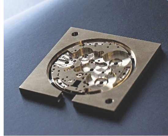
Die kleinsten Bohrungen auf der Uhrenplatine haben einen Durchmesser von lediglich 0,38 mm.
