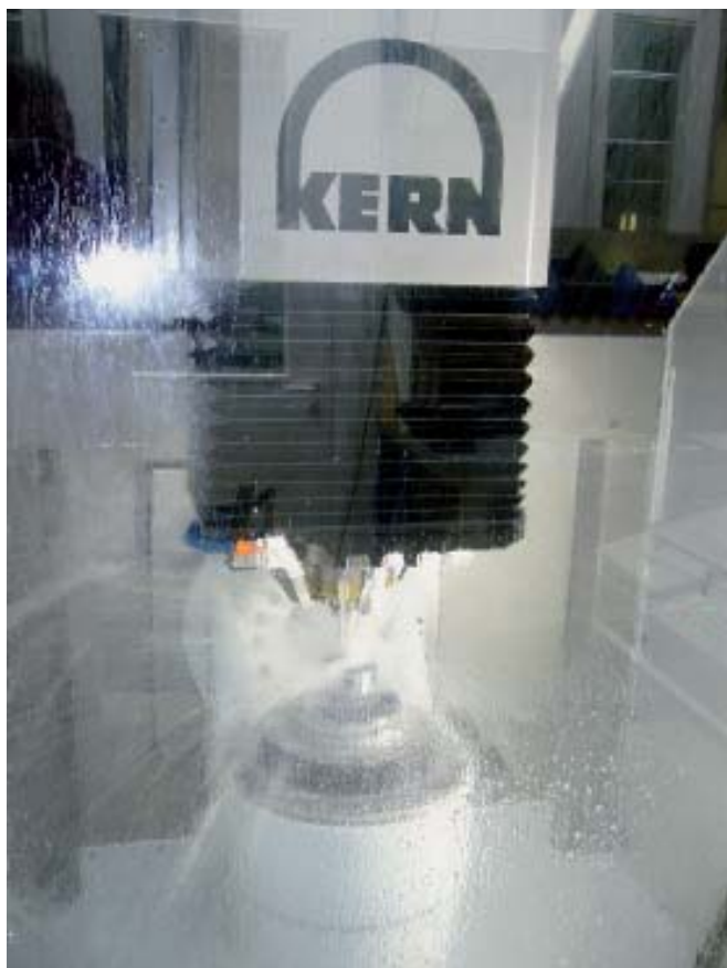
Für die Fertigung bei Kennametal ermöglichte Kern es, die zylindrischen, bis zu 300 Millimeter langen Trägerwerkzeuge fast komplett durch den Tisch zu schieben, so dass nur die zu bearbeitende Stirnseite in den Arbeitsraum ragt.
