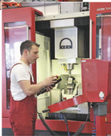
Höchste Genauigkeit im Präzisionsraum: Die Kern Triton hat Unternehmer Peter Wörgartner in einem gesonderten Bereich aufgestellt, der eine hohe Temperaturstabilität hat. Das ergänzt die maschineninterne Temperaturregelung
