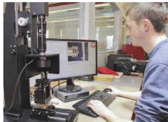
Der Mikrowerkzeuginspektor \mu -View: Nach jedem Einsatz werden die Werkzeuge bei 40- bis 450-facher Vergrößerung begutachtet und nach Abnutzung klassifiziert
