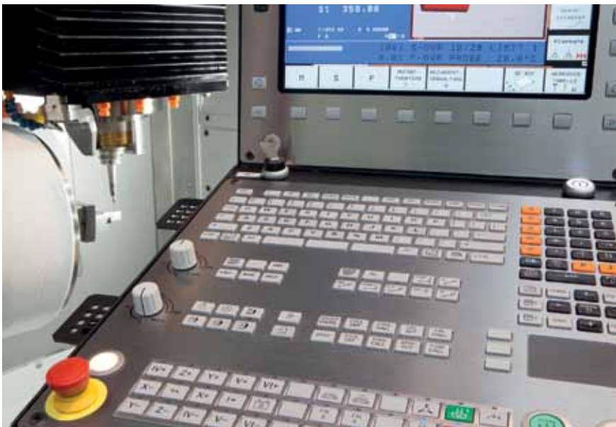
Bild 2: Die Software-Option DCM überwacht den Arbeitsraum der Maschine auf mögliche Kollisionen
