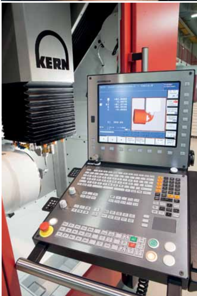
Bild 5: Keine Kollisionsgefahr im kompakten Arbeitsraum einer kundenindividuellen Kern Präzisionsmaschine: DCM stoppt die Achsbewegung, bevor es zu einem Zusammenstoß kommt (Werkbilder: Dr. Johannes Heidenhain GmbH, Traunreut)
