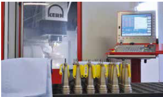
Abb. 3: Werkzeuge vor dem Einsatz: Fast 140 dieser Fräs-werkzeuge mit teilweise sehr langen Schäften kann das speziell angepasste Werkzeugmagazin der Kern Micro aufnehmen.
