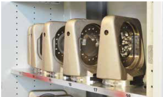
Abb. 2: Maßgeschneiderte Werkstückhalter: Um die Rohlinge optimal zu fixieren, entwickelten KERN und etkon gemeinsam spezielle Halterungen.
