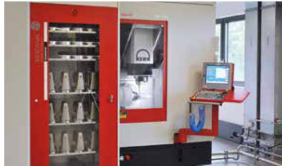
Abb. 4: Präzision für Implantate: Mit inzwischen elf Fräsmaschinen des Typs Kern Micro fertigt etkon mit höchster Genauigkeit Teile für Zahnersatz aus verschiedenen Materialien.
