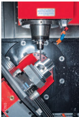
Fünffachsigem Bearbeitung einer Schwenkwelle auf einem Fräs-Drehzentrum.
