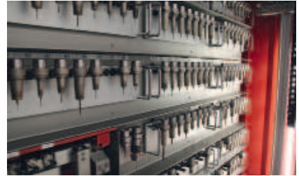
Die Experten arbeiten standardmäßig mit Fräsergrößen von 0,3 bis 2 mm. Jeder Fräser wird speziellen hauseigenen Prüfungen unterzogen.
