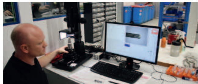
Zur Werkzeugüberprüfung vertrauen die Formenbauer auf Micro-Technik von Kern. Mit Kern \mu -View werden stetig Sichtkontrollen vorgenommen.
