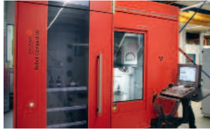
Mit dem 5-Achs-HSC-Präzisions-Bearbeitungszentrum Kern Micro können die Werkzeugbauer den hohen Fertigungsanspruch erfüllen.
