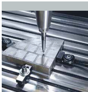
Ein Stößelkopf bearbeitet Randzonen metallischer Komponenten mit hochfrequenten Schlägen.
