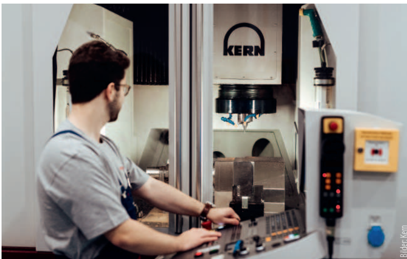
Im Jahr 2017 investierte Nicholas Hacko in eine gebrauchte Kern Pyramid Nano: „Dieses 5-Achs-Bearbeitungszentrum hat noch immer die gleiche enorme Präzision wie am Anfang und fertigt jedes Teil exakt so, wie wir es programmieren – fehlerfrei.“
