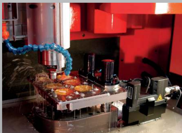
Particolari nel settore orologeria serrati tramite l'ausilio di un dispositivo a 6 posizioni
