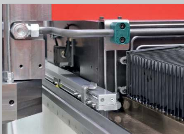
Funzionamento ottimale grazie alle guide idrostatiche
